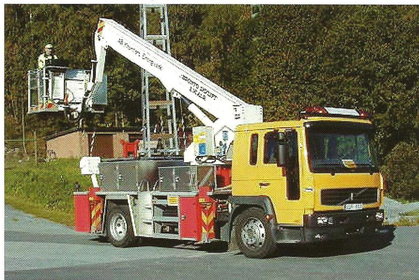
Hebebühne mit ReCoDrive – Wechseln von Glühlampen, ein Betrieb mit einem Mann.
