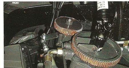
**Getriebe.** Bei minimalem Eingriff in die vorhandene Kardanwelle des LKW eingebaut.
